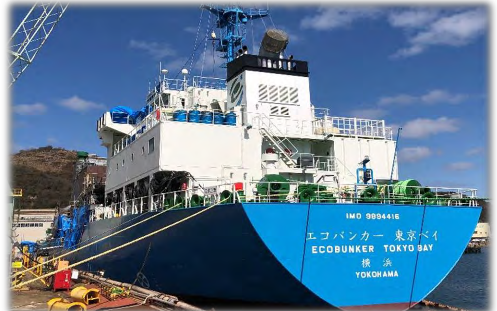
当社参画の合併会社「エコバンカー SHIPPING 社」のLNGバンカリング船
